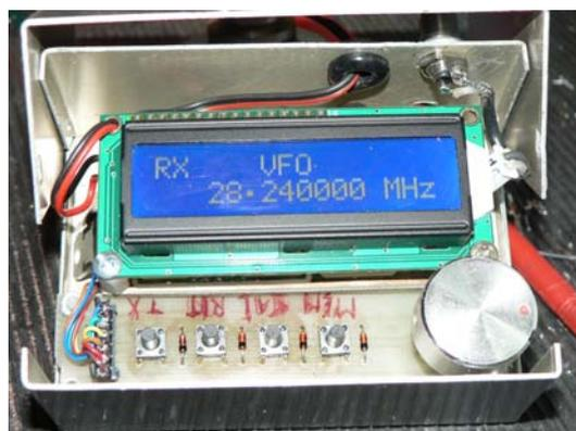
Ho implementato uno stabilizzatore a +8Vdc per alimentare sia il VFO-DDS sia il Keyer digitale (P.I.C.). Tutto il resto funziona a 12.5V mediante alimentazione esterna.
